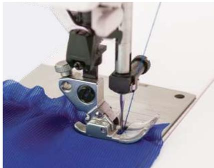
Ткань при шитье продвигается с помощью зубчатой рейки, расположенной на платформе швейной машины. Рейка продвигает нижний слой ткани.
